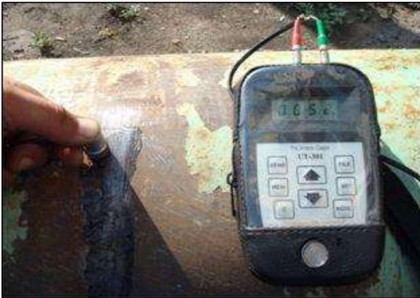
Фото 2. Замер фактической толщины стенок трубопровода с помощью ультразвукового толщиномера.
